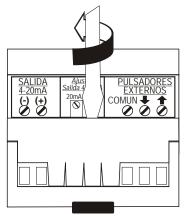
El equipo se provee calibrado de fábrica para una máxima *impedancia de 400* en la salida. No obstante si se desea efectuar una recalibración, se debe acceder a los ajustes correspondientes extrayendo el cubre-bornes inferior como lo muestra la figura.
