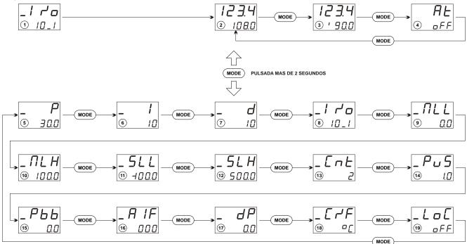
Al aplicar energía al equipo, se presenta en los displays durante 6 segundos el cuadro 1. Esta indicación, idéntica a la que muestra el cuadro 8, indica que el controlador provee entrada para sensor tipo RTD Pt100, y que su salida es de tipo lazo de corriente de 4 a 20 mA.
