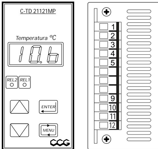
Provee un canal de lectura y dos puntos de control sobre el canal. Utiliza como sensor una termorresistencia de platino tipo Pt100, determinando un rango de medición de -19.9°C a 170°C. Tiene como salida dos relés inversores con contactos libres de tensión y corrientes máximas de 3 Amp.
