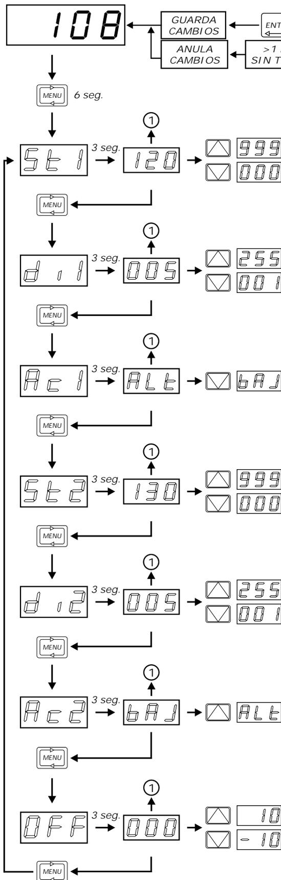
Desde cualquier punto del menú, pulsando la tecla se aceptan todos los cambios y se pasa a operación normal. Si el procesador no detecta ninguna tecla pulsada en un lapso de 1 minuto, descartará todo cambio efectuado y retornará a operación normal.
