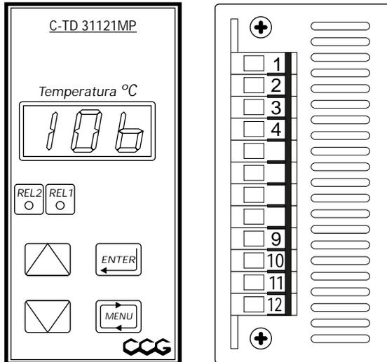
Utiliza como sensor una termocupla tipo J, determinando un rango de operación de temperaturas de 0 a 500°C.
