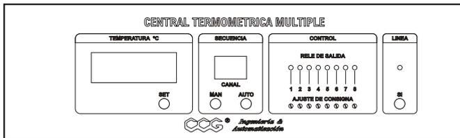
La central termométrica C-TM 30100 es un equipo diseñado para la medición de hasta 8 canales de entrada de temperatura para sensor tipo termocupla, con un punto de control por cada canal.
