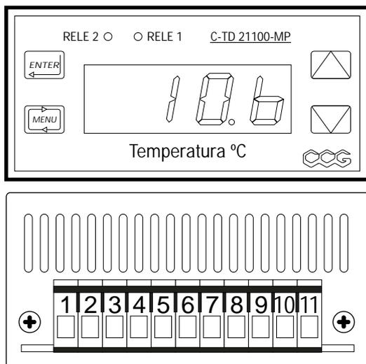
Utiliza como sensor una termorresistencia de platino tipo Pt100, determinando un rango de operación de temperaturas de -30°C a 170°C.
