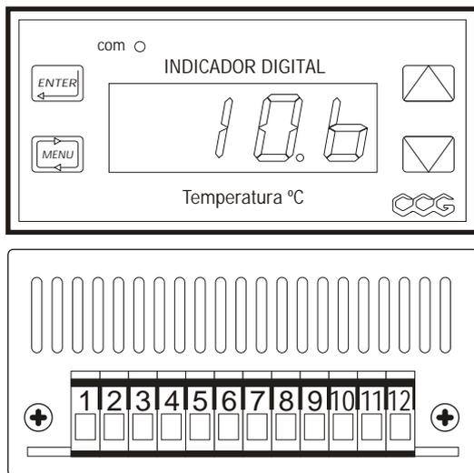
Utiliza como sensor una termorresistencia de platino tipo Pt100, determinando un rango de medición de -30°C a 170°C.
