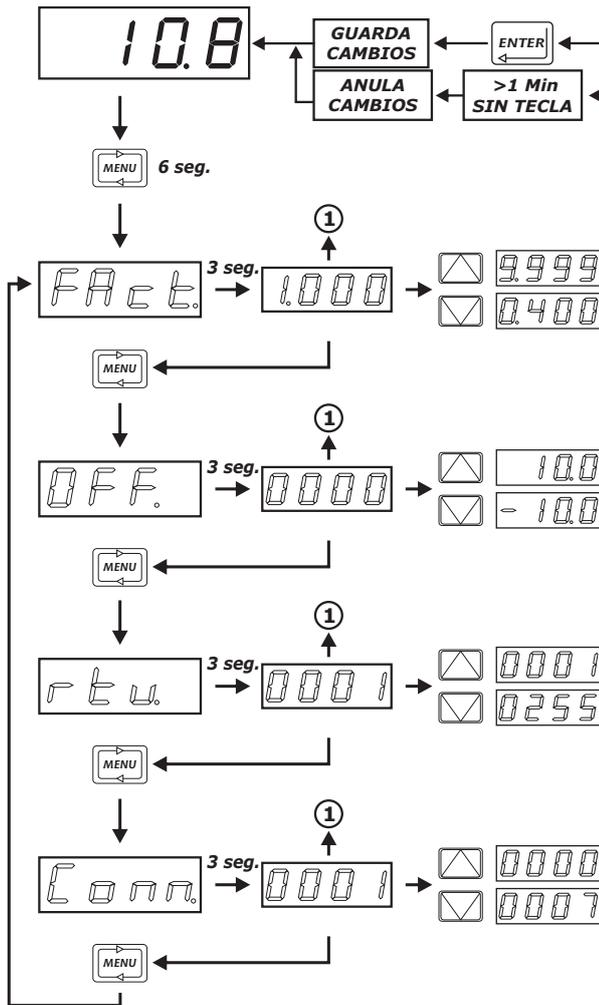
Desde cualquier punto del menú, pulsando la tecla **ENTER** se aceptan todos los cambios y se pasa a operación normal. Si el procesador no detecta ninguna tecla pulsada en un lapso de 1 minuto, descartará todo cambio efectuado y retornará a operación normal.
