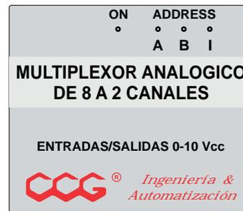
El multiplexor analógico/digital de 8 canales de entrada y 2 salidas, consta en realidad de un doble multiplexor de 4 canales de entrada y una salida, en un primer grupo se encuentran rotuladas las entradas como X0, X1, X2, X3 y la salida respectiva como X, el segundo grupo Y0, Y1, Y2, Y3 y dicha salida Y .
