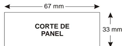
No exceda las medidas para lograr una correcta operación del reten de montaje.
