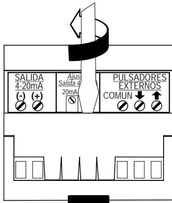
El equipo se provee calibrado de fábrica para una máxima **impedancia de 400 Ω** en la salida. No obstante si se desea efectuar una recalibración, se debe acceder a los ajustes correspondientes extrayendo el cubre-bornes inferior como lo muestra la figura.
