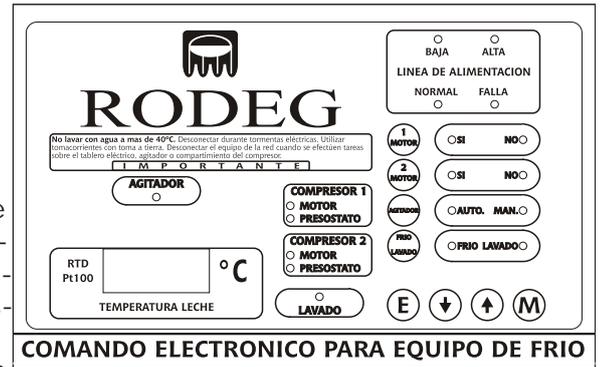
Valor de temperatura de PARADA del compresor. Se accede pulsando "M" hasta que el display indique SEt. El valor se ajusta con las teclas arriba ó abajo.
