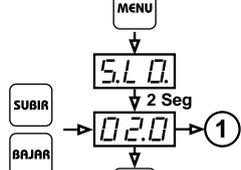
Mínimo valor de temperatura de parada del compresor que permitirá ingresar en el parámetro SEt arriba detallado.
