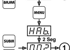
Número de compresores habilitados para arrancar. Los valores posibles son 1 ó 2. Si el valor ingresado es 1, el compresor 2 quedará deshabilitado, indicando NO en MOTOR 2 condición que no podrá variarse con la tecla correspondiente.
