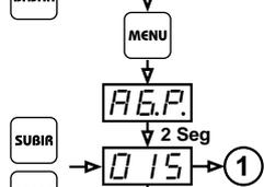
Tiempo de parada en minutos del agitador con leche fría. Este parámetro junto con el anterior programan el ciclado del agitador para evitar la separación del producto.
