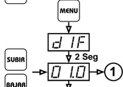
Incremento de temperatura de parada sobre Set para ordenar el arranque del compresor. Ej.: Entrando en dIF el valor 01.0, el compresor volverá a arrancar cuando la temperatura de la leche suba 1°C de la consignada en Set.
