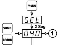
Valor de temperatura de PARADA del compresor. Se accede pulsando "MENU" hasta que el display indique SEt. El valor se ajusta con las teclas SUBIR y BAJAR.
