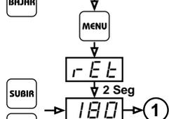
Retardo de arranque del equipo en segundos. Al conectar el equipo ó luego de una detención, el microcomputador inhibirá el arranque durante el tiempo consignado en este parámetro. El objeto es permitir el nivelado de presiones del sistema.
