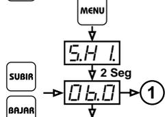
Máximo valor de temperatura de parada del compresor que permitirá ingresar SEt. Este parámetro, en conjunto con el anterior acotan el rango de acceso permitido de temperatura de parada del compresor. Ej: con los valores mostrados en el diagrama los valores de SEt permitidos irán entre 2°C y 6°C
