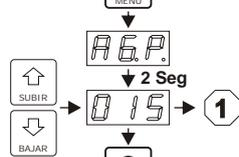
Tiempo de parada en minutos del agitador con leche fría. Este parámetro junto con el anterior programan el ciclado del agitador para evitar la separación del producto.
