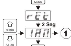
Retardo de arranque del equipo en segundos. Al conectar el equipo o luego de una detención, el microcomputador inhibirá el arranque durante el tiempo consignado en este parámetro. El objeto es permitir el nivelado de presiones del sistema.
