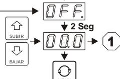
Diferencia de temperatura entre el display y un termómetro adoptado como patrón. Ej.: Si el termómetro patrón marca 0.5 °C mas que el equipo, debe entrarse el valor 00.5 en OFF. Si el patrón marca 0.3 °C menos que el equipo, debe entrarse -0.3
