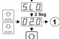
Mínimo valor de temperatura de parada del compresor que permitirá ingresar en el parámetro SET arriba detallado.
