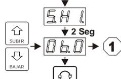
Máximo valor de temperatura de parada del compresor que permitirá ingresar SET. Este parámetro, en conjunto con el anterior acotan el rango de acceso permitido de temperatura de parada del compresor Ej. Con los valores mostrados en el diagrama los valores de SET permitidos irán entre 2°C y 6 °C
