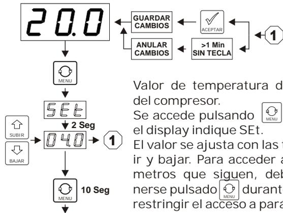
Valor de temperatura de PARADA del compresor. Se accede pulsando **MENU** hasta que el display indique SET. El valor se ajusta con las teclas subir y bajar. Para acceder a los parámetros que siguen, debe mantenerse pulsado **MENU** durante un tiempo aproximado a 10 segundos. Puede utilizarse esto para restringir el acceso a parámetros reservados a personal técnico solamente.
