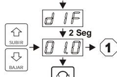
Incremento de temperatura de parada sobre Set para ordenar el arranque del compresor. Ej.: Entrando en dIF el valor 01.0, el compresor volverá a arrancar cuando la temperatura de la leche suba 1° C de la consignada en Set.
