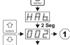
Número de compresores habilitados para arrancar. Los valores posibles son 1 o 2. Si el valor ingresado es 1, el compresor 2 quedará deshabilitado, indicando NO en MOTOR 2 condición que no podrá variarse con la tecla correspondiente.
