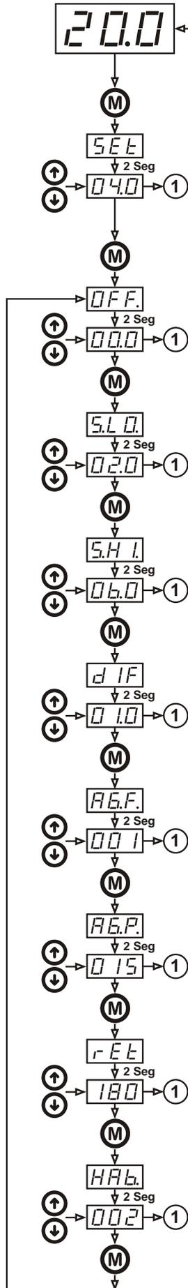
Valor de temperatura de PARADA del compresor. Se accede pulsando "M" hasta que el display indique SEt. El valor se ajusta con las teclas arriba ó abajo.
