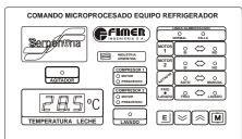
Valor de temperatura de PARADA del compresor. Se accede pulsando "M" hasta que el display indique SEt. El valor se ajusta con las teclas arriba ó abajo.
