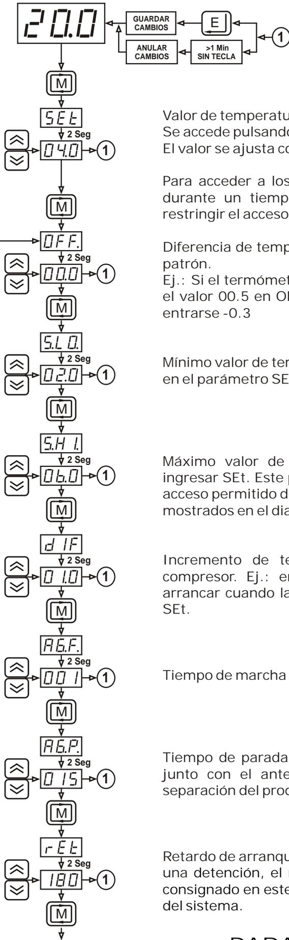
Valor de temperatura de PARADA del compresor. Se accede pulsando "M" hasta que el display indique SEt. El valor se ajusta con las teclas arriba ó abajo.
