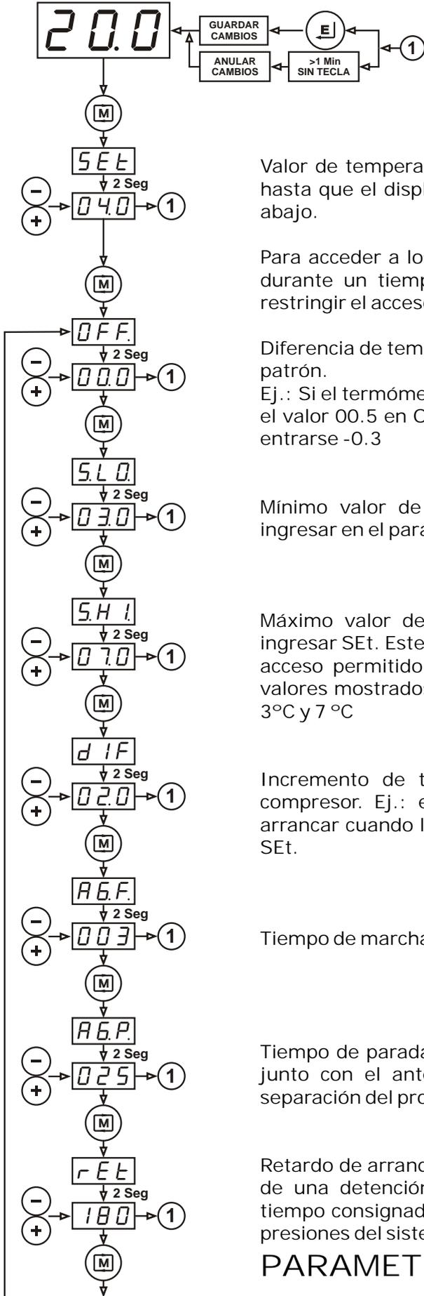
Valor de temperatura de PARADA del compresor. Se accede pulsando "M" hasta que el display indique SEt. El valor se ajusta con las teclas arriba ó abajo.
