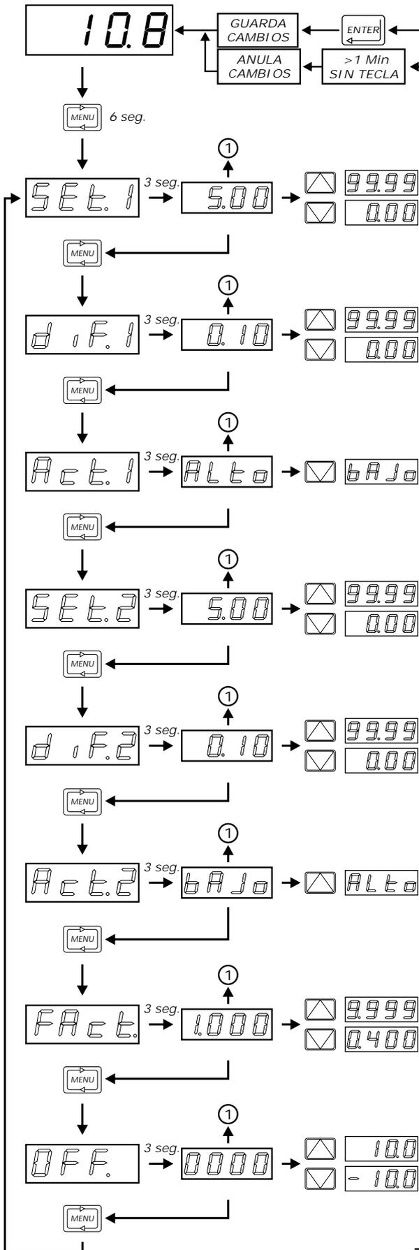
Desde cualquier punto del menú, pulsando la tecla **ENTER** se aceptan todos los cambios y se pasa a operación normal. Si el procesador no detecta ninguna tecla pulsada en un lapso de 1 minuto, descartará todo cambio efectuado y retornará a operación normal. Pulsando la tecla **MENU** durante un lapso de 6 segundos se accede a la configuración de los parámetros de funcionamiento del equipo.
