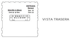
Pin N° 11 = Fase Línea de Alimentación Pin No 10 = Neutro 220Vca - 50/60Hz  $Pin N^{\circ} O8 = (+) Positivo$ Salida señal 4-20mA  $Pin N^{\circ} O6 = (-) Negativo$ Carga Máxima 250 Ohm  $Pin N^{\circ} O5 = RP$ Sensor de temperatura  $Pin N^{\circ} O3 = RP$ RTD Pt100
