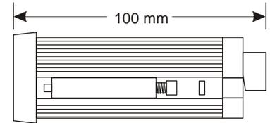
No exceda las medidas para lograr una correcta operación del reten de montaje.
