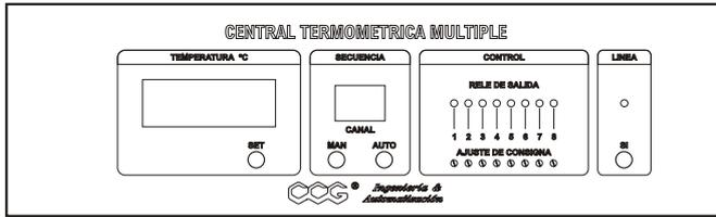
La central termométrica C-TD 20100 es un equipo diseñado para la medición de hasta 8 canales de entrada de temperatura para sensor tipo RTD Pt100, con un punto de control por cada canal preparado para calefacción ó refrigeración. La lectura se provee en un display tipo LED de 3 1/2 dígitos de alto brillo, con resolución de 0,1 °C. Un segundo display de menor tamaño, indica el número del canal visualizado.
