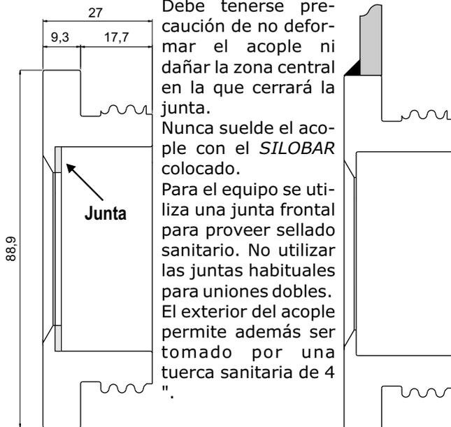
Debe tenerse precaución de no deformar el acople ni dañar la zona central en la que cerrará la junta.
