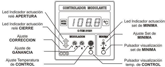
En el frente del controlador, pueden observarse dos preset de regulación rotulados "I" y "K".
