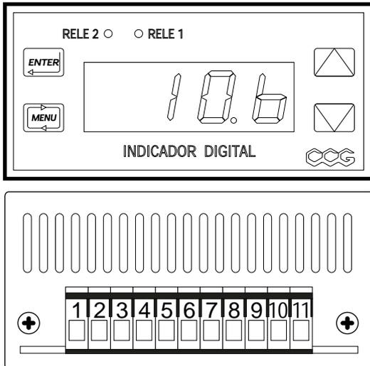
La señal de entrada es normalizada 4-20mA, en configuración de dos o tres hilos; y tiene como salida uno o dos relés inversores con contactos libres de tensión y una corriente máxima de 5 Amper resistivos.
