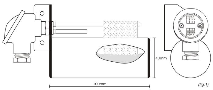
El método de medición de humedad relativa consiste esencialmente de dos sensores independientes de temperatura; uno usado como sensor de bulbo seco y el otro como sensor de bulbo húmedo (fig. 1).
