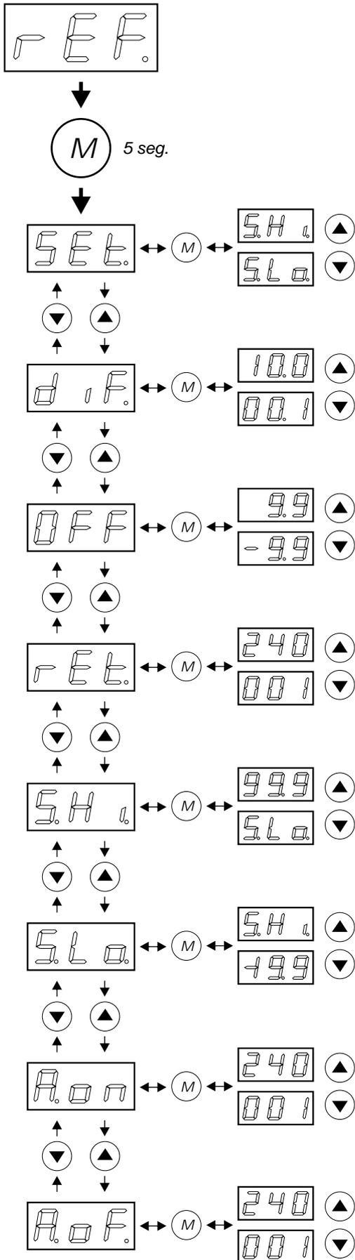
Desde cualquier punto del menú, pulsando la tecla (E) se aceptan todos los cambios y se pasa a operación normal. Si el procesador no detecta ninguna tecla pulsada en un lapso de 1 minuto, descartará todo cambio efectuado y retornará a operación normal.
